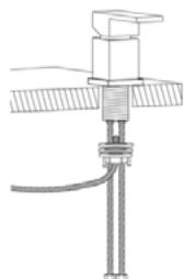
Connectez les flexibles de la poignée à l'alimentation en eau. Utilisez ensuite la clé pour serrer les écrous de fixation, sans trop forcer.
