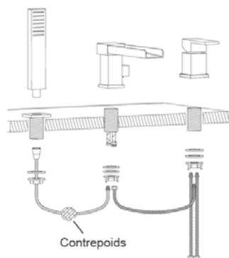
Connectez le flexible (gris) de la poignée du mitigeur au bec de bain. Insérez le contrepois sur le flexible souple de la douchette puis reliez le bec de bain à la douchette.
