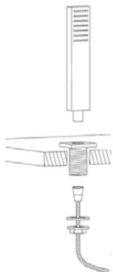
Insérez le support douchette dans le trou de la baignoire. Placez la rondelle en caoutchouc, la rondelle métallique en les faisant glisser jusqu'à ce qu'elles soient en contact avec le dessous du support du robinet. Ensuite, serrez l'écrou à la main puis serrez-à l'aide d'une clé à molette sans trop forcer.
