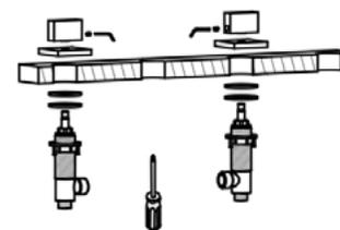
Positionnez les rosaces et les poignées sur les trous percés. Placez les rondelles en caoutchouc et les rondelles métalliques sur les tiges filetées du corps de vos poignées. Insérez les corps des poignées sous la plage de votre baignoire. Serrez l'écrou à la main, puis à l'aide d'une clé à molette, sans trop forcer. Positionnez correctement les poignées et serrez-les à l'aide de la clé Allen.
