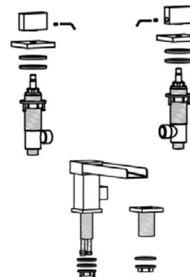
Retirez les rondelles en caoutchouc et les rondelles métalliques des différents éléments du robinet de baignoire (poignées, bec et tige filetée de la douchette).
