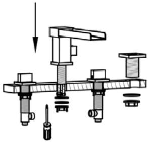
Insérez la tige filetée du bec et la tige filetée de la douchette dans les trous restants. Placez les rondelles en caoutchouc puis les rondelles métalliques sur les tiges filetées en les faisant glisser jusqu'à ce qu'elles soient en contact avec le dessous du support du robinet. Ensuite, serrez l'écrou à la main puis serrez à l'aide d'une clé à molette sans trop forcer.
