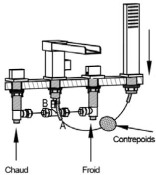
Connectez les tuyaux d'alimentation d'eau chaude et d'eau froide sur les poignées. Puis raccordez les poignées au bec du robinet. Enfin placez le contrepoids sur le flexible de la douchette puis connectez les extrémités du flexible à la douchette et au bec du robinet.
