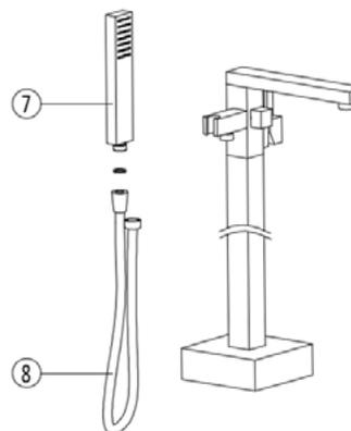
Placez un joint dans chaque extrémité du flexible de douche (8). Vissez une extrémité du flexible sur la douchette à main (7) et l'autre extrémité au support douchette placé sur le corps de robinet. Installez ensuite la douchette à main sur son support.
