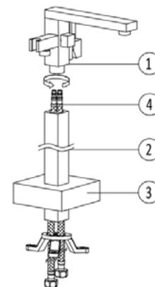
Assemblez le tube droit (2) et la plaque décorative (3). Insérez les flexibles (4) dans le tube droit et vissez-les dans la tige filetée du corps du robinet (1). Glissez les flexibles dans le support de sol (trépied).
