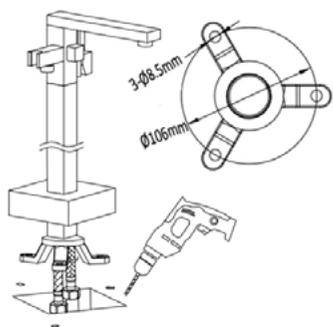
A l'aide de la perceuse, forez 3 trous dans le sol aux dimensions indiquées sur le schéma.
