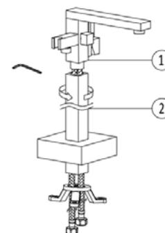
Commencez par visser manuellement le tube droit (2) sur le corps de robinet (1). Ensuite, serrez les vis de fixation à l'aide de la clé Allen fournie.
