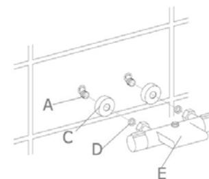
Faites glisser les rosaces (C) sur les fixations du mitigeur en conservant un accès aux écrous.
