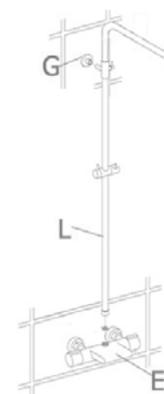
Présentez la colonne de douche (L) sur le corps de robinet (E) afin de déterminer l'emplacement de fixation du support mural (G). N'oubliez pas de vérifier la hauteur totale de la douche.
