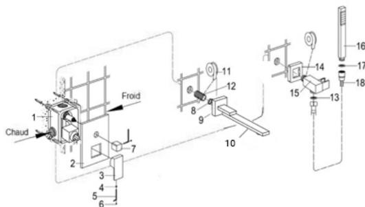
Découpez dans le mur l'emplacement du corps d'encastrement, selon ses dimensions. Prévoyez les saignées autour de votre corps encastré vers vos platines \* (non fournies) de sortie (bec et douchette) afin de pouvoir installer vos tuyaux d'eau de type PER, cuivre... (non fournis). Positionnez le corps d'encastrement dans le trou du mur. Utilisez le niveau à bulle pour vous assurer que la valve est droite et de niveau. Vissez le boîtier à l'aide du tournevis.
