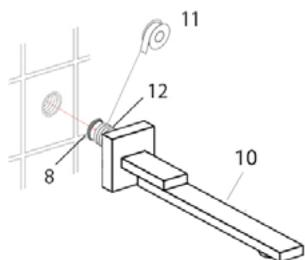
Placez le joint d'étanchéité (8) entre la tige filetée (12) et le bec de la baignoire (10) puis vissez les éléments entre eux. Appliquez ensuite du ruban téflon (11) sur la tige filetée. Insérez ensuite la tige filetée du bec dans la rosace puis vissez-la sur la sortie d'eau murale (platine).
