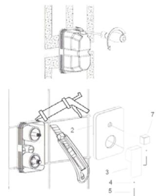
Une fois le revêtement posé, retirez le couvercle de protection. Appliquez un joint silicone autour du boîtier puis faites glisser la plaque de finition (2) sur les boutons du boîtier jusqu'à ce qu'elle soit en contact avec le mur. Installez ensuite la poignée (3) et l'inverseur (7) puis serrez les vis de réglage (4) à l'aide de la clé Allen (5).
