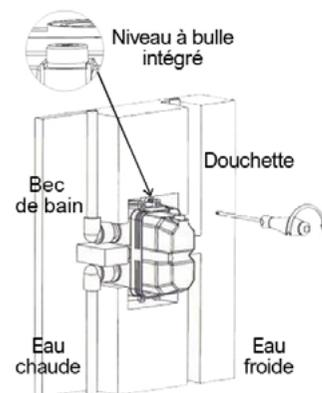
Enveloppez les tuyaux d'eau de ruban téflon. Connectez les conduites d'alimentation en eau chaude et eau froide au corps d'encastrement ainsi que les tuyaux d'alimentation en eau des différents éléments (bec, douchette). Ouvrez l'alimentation en eau pour tester l'installation et vérifier qu'il n'y a pas de fuites. Laissez en place le couvercle de protection du boîtier d'encastrement pour réaliser la pose du revêtement mural.
