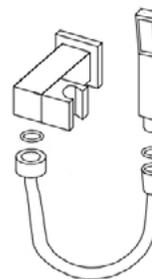
Placez les joints d'étanchéité aux deux extrémités du flexible de douche. Ensuite, vissez une extrémité du flexible sur le support douche et l'autre extrémité à la douche à main.
