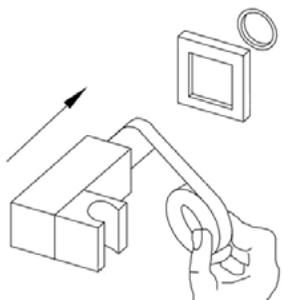
Appliquez du ruban téflon sur l'extrémité fileté du support douche. Faites glisser la rosace sur la tige fileté puis vissez le support douche sur la sortie d'eau murale à travers la platine.
