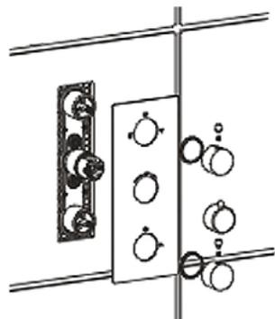
Une fois le mur fini, dévissez le couvercle de protection puis appliquez un joint silicone autour du corps d'encastrement. Ensuite, faites glisser la plaque décorative sur les boutons du boîtier jusqu'à ce qu'elle soit en contact avec le mur. Installez les poignées et serrez les vis à l'aide de la clé Allen.
