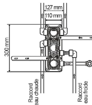
Placez le boîtier d'encastrement dans le mur. Assurez-vous qu'il soit bien de niveau et fixez-le à l'aide du tournevis. Appliquez du ruban téflon sur l'extrémité des tiges filetées des tuyaux d'alimentation en eau et des conduites d'eau de la tête de douche et de la douchette et connectez-les au boîtier d'encastrement.
