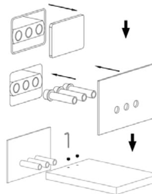
Pour procéder à l'installation de la tête de douche, retirez le couvercle de protection du corps d'encastrement. Appliquez un joint silicone autour du corps d'encastrement et vissez les tiges filetées sur le boîtier après les avoir enveloppé de ruban téflon. Ensuite, faites glisser la plaque décorative sur les tiges. Installez la tête de douche et serrez les vis à l'aide de la clé Allen.
