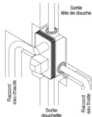
Positionnez le boîtier dans le mur et vissez-le à l'aide du tournevis après avoir vérifié son horizontalité à l'aide du niveau à bulle intégré. Appliquez du ruban téflon sur les filetages des tuyaux d'eau. Connectez vos tuyaux d'alimentation en eau ainsi que les tuyaux d'alimentation de la tête de douche et de la douchette au corps encastré.
