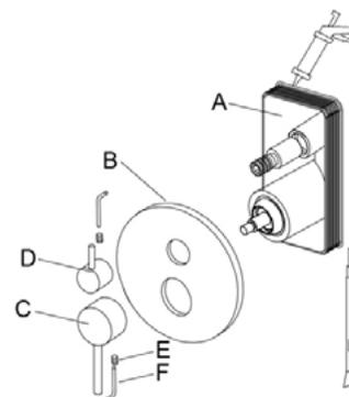
Dévissez le couvercle de protection du boîtier une fois le mur fini. Si nécessaire, découpez au cutter l'excédent qui dépasse du boîtier afin de le rendre affleurant à la surface du mur. Appliquez un joint silicone autour du corps d'encastrement. Faites glisser la plaque décorative (B) sur les boutons du boîtier, jusqu'à ce qu'elle soit en contact avec le mur. Ensuite, installez la poignée (C) et la poignée (D) puis serrez les vis de fixation (E) des deux poignées avec la clé Allen (F).
