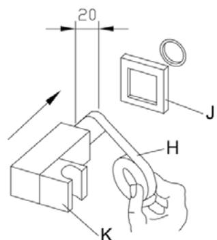
Enroulez le filetage du support de douche de ruban téflon (H). Positionnez la rosace (J) sur la sortie d'alimentation en eau murale et vissez le support douchette (K) sur la sortie murale (platine).
