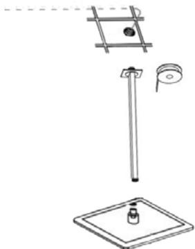
Ouvrez votre arrivée d'eau et laissez couler pendant 1 minute pour purger toutes les impuretés présentes dans vos différentes sorties d'eau. Appliquez le ruban téflon sur le filetage du bras de douche avant de l'installer sur la sortie d'alimentation de plafond (platine). Vissez ensuite la tête de douche sur le bras.
