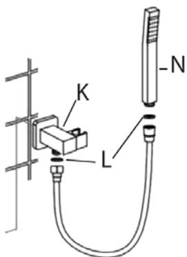
Placez les joints d'étanchéité (L) sur les deux extrémités du flexible de douche. Connectez ensuite une extrémité du flexible à la douchette à main (N) et l'autre extrémité dans le support douchette (K).
