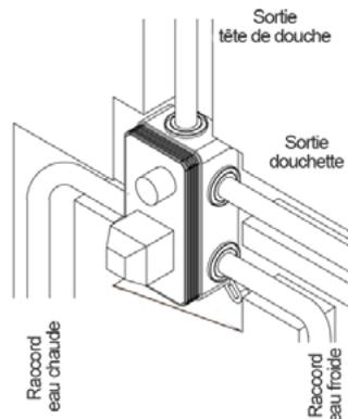
Placez le boîtier dans le mur. Utilisez le niveau à bulle pour vous assurer que le boîtier est bien droit. Une fois bien positionné, fixez le solidement en serrant les vis à l'aide du tournevis. Enroulez le filetage des tuyaux d'eau de ruban téflon. Connectez les tuyaux d'eau au corps du boîtier.
