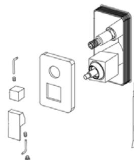
Une fois le revêtement mural posé, désérrez les vis et retirez le couvercle de protection. Si besoin, découpez au cutter la partie du corps d'encastrement qui dépasse, de façon à ce qu'il affleure la surface du mur. Appliquez un joint silicone autour du boîtier. Faites glisser la plaque décorative sur les boutons jusqu'à ce qu'elle soit en contact avec le mur. Installez la poignée et le bouton inverseur puis serrez les vis de réglage à l'aide de la clé Allen.
