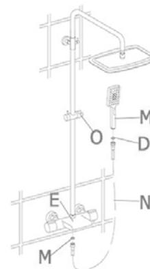
Vissez l'embout du flexible (N) sur le corps de robinet (E) puis vissez à la main l'autre extrémité du flexible à la douche (M).
