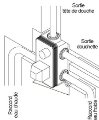
Placez le boîtier dans le mur et assurez-vous qu'il est bien droit. Une fois bien positionné, fixez-le solidement en serrant les vis à l'aide du tournevis. Appliquez du ruban téflon sur le filetage des tuyaux d'eau puis connectez-les au corps encastré. Assurez-vous que toutes les connexions sont correctement serrées et étanches.
