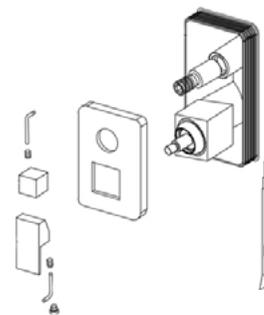
Une fois le revêtement mural posé, retirez le couvercle de protection. Si besoin, découpez au cutter l'excédent du boîtier de façon à ce qu'il affleure la surface du mur. Appliquez un joint silicone autour du corps d'encastrement. Glissez la plaque décorative sur les boutons, jusqu'à ce qu'elle soit en contact avec le mur. Ensuite, installez la poignée et le bouton inverseur puis serrez les vis de réglage à l'aide de la clé Allen.
