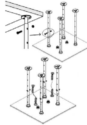
Placez les tubes 2 à l'arrière de la tête de douche conformément au schéma puis assemblez les tubes 2 avec les tubes 1 en les fixant avec les vis et les boulons. (Il est important de noter que les tiges des tubes sont réglables, ce qui vous permet d'ajuster la hauteur de la tête de douche selon vos besoins.) Ensuite connectez les flexibles d'eau.
