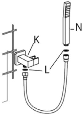
Placez les joints d'étanchéité sur les deux extrémités du flexible de douche. Connectez ensuite une extrémité du flexible à la douchette à main et l'autre extrémité au support douchette.
