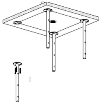
Tracez au crayon les repères pour installer les tubes 1 dans le plafond. Percez les trous sur les repères et insérez les chevilles puis placez les tubes et vissez.
