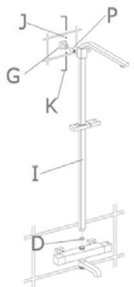
Vissez ensuite la colonne de douche (I) au corps de robinet sans oublier d'y insérer le joint d'étanchéité (D). Fixez la partie haute de la colonne dans le support de fixation (G). Puis serrez à l'aide d'une clé Allen (K).
