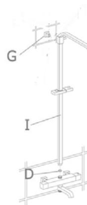
Présentez la colonne de douche (I) sur le corps de robinet (E) pour déterminer le point de fixation du support mural (G). Pensez à vérifier la verticalité de la colonne à l'aide d'un niveau. Faites un repère au crayon puis retirez la colonne de douche.
