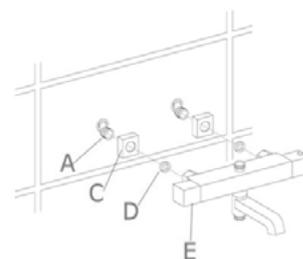
Faites glisser les rosaces (C) sur les raccords (A). Placez le corps de robinet (E) avec ses joints (D) sur les raccords. Serrez les écrous à l'aide d'une clé à molette. Pensez à protéger la partie visible de l'écrou lors du serrage afin de ne pas le rayer. Ouvrez l'alimentation en eau et vérifiez qu'il n'y a pas de fuites.
