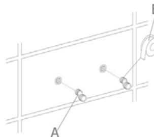
Vérifiez l'état de vos raccords et assurez-vous que l'entraxe entre les arrivées d'eau est identique à celui du corps de robinet. Appliquez le ruban téflon (B) autour des raccords excentrés (A). Insérez les raccords enrubannés dans les arrivées d'eau. Appliquez un joint silicone autour des raccords pour assurer une étanchéité optimale.
