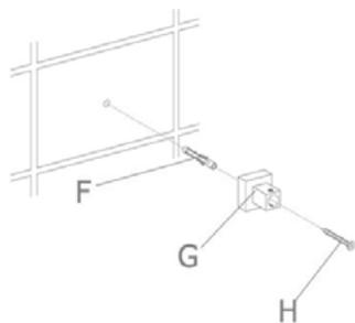
Percez le mur, insérez la cheville (F) et vissez (H) le support de fixation (G) de la colonne.
