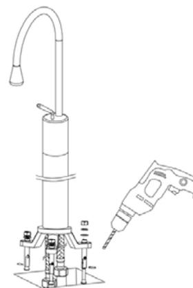
Percez des trous au sol et vissez les boulons d'expansion après avoir connecté les flexibles aux tuyaux d'alimentation en eau.
