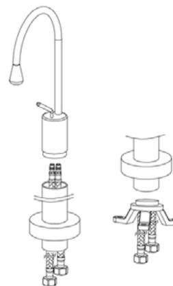
Vissez les flexibles sur le corps du robinet puis insérez les flexibles dans le tube droit. Vissez ensuite le tube droit sur le corps principal. Placez ensuite le cache décoratif sur le tube droit puis faites glisser le support de fixation sur les flexibles.
