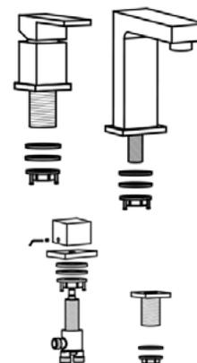
Retirez les rondelles en caoutchouc et les rondelles métalliques des différents éléments du robinet de baignoire (poignée, inverseur, bec et tige filetée de la douchette).
