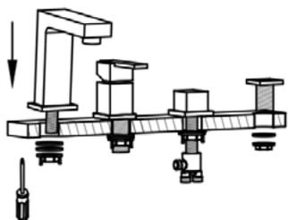
Insérez le bec du robinet et le filetage de la douchette dans les trous restants. Placez la rondelle en caoutchouc suivie de la rondelle métallique à l'extrémité de chaque tige filetée et serrez l'écrou.
