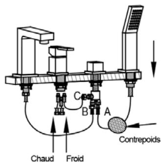
Connectez les tuyaux d'alimentation d'eau chaude et d'eau froide sur la poignée. Puis raccordez le bec du robinet (B) ainsi que la poignée (C) à l'inverseur. Enfin placez le contrepoids sur le flexible de la douchette (A) puis connectez les extrémités du flexible à la douchette et l'inverseur.
