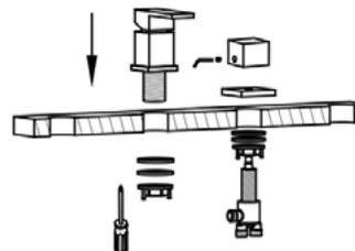
Placez l'inverseur et sa rosace ainsi que le filetage de la poignée dans les trous prévus à cet effet. Placez la rondelle en caoutchouc puis la rondelle métallique à l'extrémité des tiges filetées des deux éléments et serrez l'écrou. Positionnez correctement le bouton inverseur et serrez la vis de fixation à l'aide de la clé Allen.
