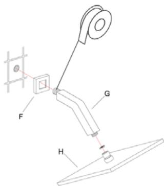
Enveloppez la tige filetée du bras de douche (G) de ruban téflon. Insérez la tige filetée dans la rosace (F) puis vissez le bras de douche sur la sortie d'eau murale à travers la platine. Ensuite, vissez la tête de douche (H) sur le bras de douche (G) en insérant un joint d'étanchéité entre les deux éléments du pack de douche.
