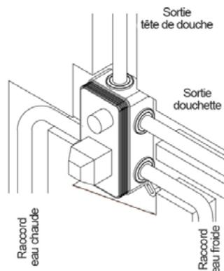
Enveloppez les tuyaux d'eau de ruban téflon puis connectez-les au boîtier d'encastrement, comme indiqué sur le schéma.
