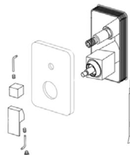
Retirez le couvercle de protection du corps d'encastrement une fois le mur fini. Si besoin, découpez au cutter l'excédent du boîtier de façon à ce qu'il affleure la surface du mur.
