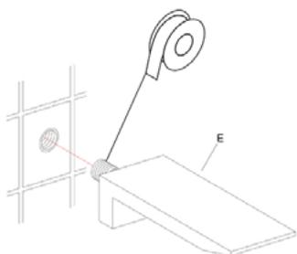
Enroulez le ruban téflon sur l'extrémité du filetage du bec de baignoire (E). Puis, vissez la tige filetée du bec sur le raccord du tuyau d'alimentation en eau à travers la platine.
