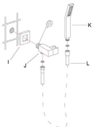
Appliquez du ruban téflon sur le filetage du support douchette (J). Insérez le support douchette dans la rosace (I) puis vissez-le à la conduite d'alimentation en eau murale sur la platine. Insérez un joint dans chaque extrémité du flexible de douche (L). Connectez le flexible de douche au support mural (J) et à la douchette (K).
