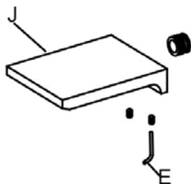
Vissez le bec sur la tige filetée, puis utilisez la clé Allen pour serrer les vis de fixation.
