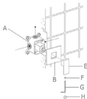
Enroulez le ruban téflon autour du filetage du bec, puis vissez la tige filetée sur la conduite d'alimentation en eau murale (platine).
