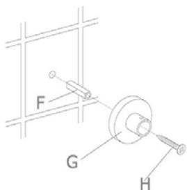
Utilisez une perceuse pour percer le trou marqué au crayon. Insérez la cheville (F) dans le trou et vissez avec la vis (H) le support de fixation (G) de la colonne de douche.
