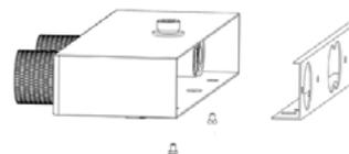
Placez la platine de fixation sur le mur en alignant les trous avec les raccords d'eau. Ensuite, serrez les 4 vis pour fixer solidement la platine.
