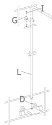
Vissez la colonne de douche (L) sur le corps de robinet en veillant à insérer le joint d'étanchéité (D).
