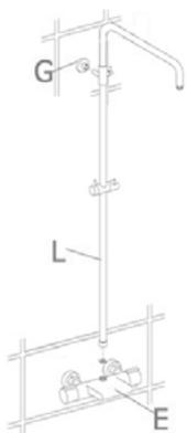
Présentez la colonne de douche (L) sur le corps de robinet (E) afin de déterminer l'emplacement de fixation du support mural (G). N'oubliez pas de vérifier la hauteur totale de la douche. \* Si la hauteur totale vous convient, vérifiez à présent la verticalité de la colonne à l'aide d'un niveau à bulle. Ensuite, marquez l'emplacement du support mural avec un crayon avant de retirer la colonne de douche.
