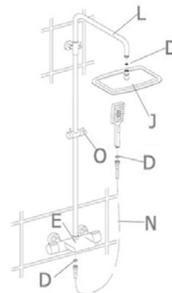
Vissez à la main la tête de douche (J) sur le bras de douche (L) en veillant à ne pas oublier le joint (D). Placez les joints (D) aux deux extrémités du flexible. Vissez l'embout du flexible (N) sur le corps de robinet (E) puis vissez à la main l'autre extrémité du flexible sur la douchette (M).
