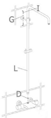
Vissez la colonne de douche (L) sur le corps de robinet sans oublier d'y insérer le joint d'étanchéité (D).
