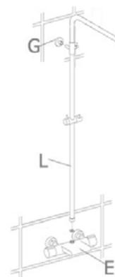
Présentez la colonne de douche (L) sur le corps de robinet (E) pour déterminer point de fixation du support mural (G). Pensez à vérifier la verticalité de la colonne à l'aide d'un niveau. N'oubliez pas de vérifier la hauteur totale de la douche.\*
