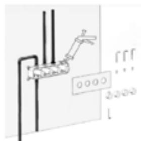
Une fois le revêtement mural posé, retirez à l'aide du tournevis le couvercle de protection du boîtier d'encastrement. Desserrez les vis de fixation à l'aide de la clé Allen afin de retirer les poignées du corps encastré. Appliquez ensuite un joint silicone autour du corps encastré.
