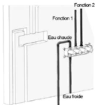
Enroulez les tuyaux d'alimentation en eau de ruban téflon puis raccordez-les au corps encastré. Assurez-vous que toutes les connexions sont correctement serrées et étanches.
