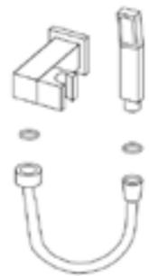
Insérez un joint d'étanchéité sur chaque extrémité du flexible de douche. Connectez une extrémité du flexible à la douche à main puis connectez l'autre extrémité au support douche.
