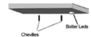
Placez le support au plafond et marquez au crayon les 2 repères des fixations. Percez, selon les dimensions des chevilles du support, les repères marqués au crayon puis insérez les chevilles dans les trous. Ensuite, vissez le boîtier Leds.
