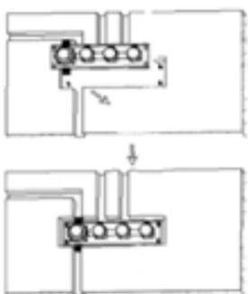
Placez les trous de fixation du boîtier sur les chevilles puis utilisez le tournevis pour serrer les vis.
