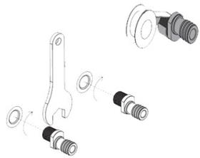
Enroulez le ruban téflon autour des raccords excentrés. Insérez les raccords excentrés enrubannés dans les arrivées d'eau et serrez-les à l'aide de la clé à molette. Appliquez un joint silicone autour des raccords excentrés.
