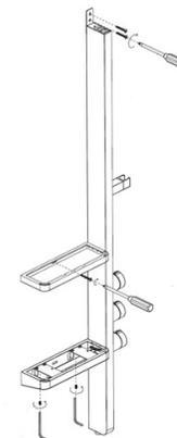
Placez la colonne de douche contre le mur en alignant les trous de la tablette inférieure avec les raccords excentrés et en faisant correspondre les trous de fixation de la colonne aux chevilles. Serrez les vis de fixation de la colonne de douche dans les chevilles. Ensuite, serrez les vis sous la tablette à l'aide de la clé Allen.
