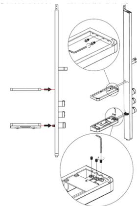
Insérez les vis dans les trous de la tablette supérieure puis serrez les vis dans les trous latéraux de la colonne de douche à l'aide de la clé Allen. Ensuite installez la deuxième étagère sur la colonne et serrez les vis avec la clé Allen comme indiqué sur le schéma.
