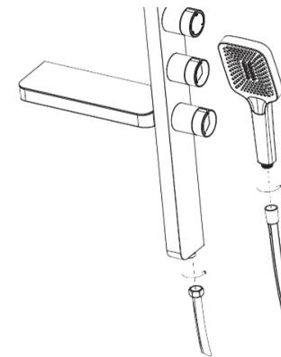
Placez un joint d'étanchéité à chaque extrémité du flexible de douche. Vissez une extrémité du flexible sur la colonne de douche puis vissez l'autre extrémité sur la douche.
