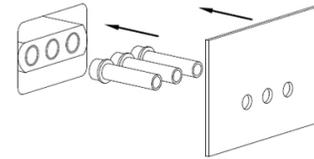
Retirez les deux bouchons blancs et installez à la place, les tiges dorées. Insérez la tige argentée dans le trou restant. Serrez les tiges à l'aide de la clé Allen. Faites glisser la plaque décorative sur les tiges jusqu'à ce qu'elle soit en contact avec le mur.
