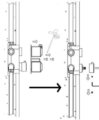
Une fois le mur fini, dévissez le couvercle de protection, à l'aide du tournevis. Si besoin, découpez au cutter l'excédent du boîtier de façon à ce qu'il affleure la surface du mur. Appliquez un joint silicone autour du corps encastré. Ensuite, desserrez les vis du bouton d'activation de l'eau à l'aide de la clé Allen afin de le retirer.
