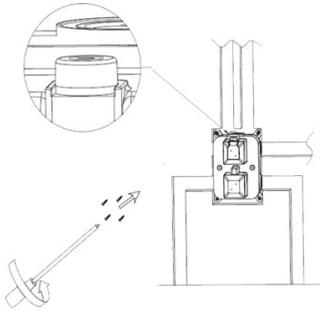
Placez le boîtier gris dans le mur. Utilisez le niveau à bulle intégré pour vous assurer que le boîtier est bien droit. Marquez au crayon les repères de fixation. Percez les trous marqués puis insérez les chevilles dans les trous.
