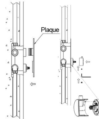
Faites glisser la plaque décorative sur les boutons du boîtier jusqu'à ce qu'elle soit en contact avec le mur. Puis, installez le bouton d'activation de l'eau en veillant à bien le positionner dans son sens d'origine et serrez les vis de fixation à l'aide de la clé Allen.
