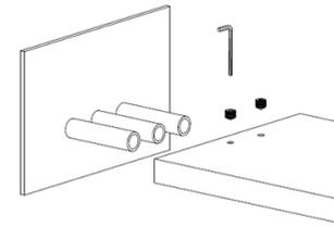
Installez la tête de douche sur les tiges puis serrez les vis à l'aide de la clé Allen.
