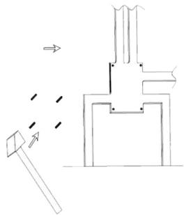
Positionnez le boîtier dans le mur en alignant les trous de fixation sur les chevilles puis serrez les vis à l'aide du tournevis. Appliquez du ruban téflon autour et dans le même sens que le filetage des tuyaux d'alimentation en eau puis connectez les tuyaux d'eau au corps d'encastrement.
