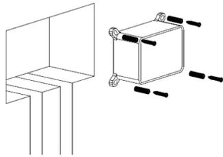
Placez le corps encastré orange dans le mur en vous assurant qu'il est bien droit à l'aide du niveau à bulle intégré. Marquez au crayon les repères de fixation du boîtier puis percez les trous marqués et insérez les chevilles dans les trous. Vissez le boîtier.
