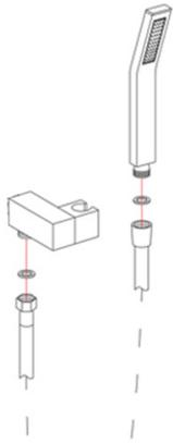
Placez les joints d'étanchéité aux deux extrémités du flexible de douche. Ensuite, vissez une extrémité du flexible sur le support douchette et l'autre extrémité à la douchette à main.
