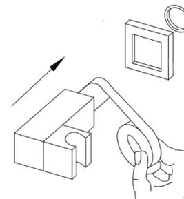
Appliquez du ruban téflon sur le filetage du support douchette. Insérez la tige filetée du support douchette dans la rosace puis vissez-la à travers la platine sur la sortie d'eau murale.
