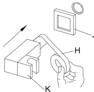
Appliquez du ruban Téflon (H) sur la tige fileté du support mural (K). Insérez la tige fileté du support dans la rosace (J) et vissez-la à travers la platine sur la sortie d'eau murale.
