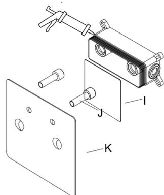
Une fois le mur fini, retirez le couvercle de protection (I). Si besoin, découpez au cutter l'excédent de plastique du boîtier de façon à ce qu'il affleure la surface du mur. Appliquez un joint silicone autour du corps encastré. Vissez les tiges (J) sur le corps encastré. Ensuite, faites glisser la plaque décorative (K) sur les tiges jusqu'à ce qu'elle soit en contact avec le mur.
