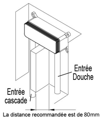
Placez le corps d'encastrement de la tête de douche dans le mur. Assurez-vous qu'il est bien droit à l'aide du niveau intégré puis vissez-le à l'aide du tournevis. Connectez ensuite les tuyaux d'alimentation en eau après les avoir enroulés de ruban téflon.
