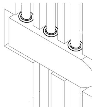
Placez le corps d'encastrement dans le mur, assurez-vous qu'il est bien à niveau. Marquez avec un crayon l'emplacement des 4 fixations. Percez ensuite les 4 trous puis insérez les chevilles. Vissez le corps encastré. Enroulez de ruban téflon les tuyaux d'eau puis connectez-les au boîtier. Ouvrez l'arrivée d'eau pour tester l'installation et vérifier qu'il n'y a pas de fuites. Puis fermez l'arrivée d'eau pour continuer l'installation.
