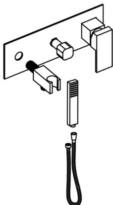
Appliquez du ruban téflon sur le filetage du support douchette puis vissez-le dans la sortie murale de votre corps encastré. Placez un joint d'étanchéité dans chaque extrémité du flexible puis raccordez le flexible sur la douchette et sur le support douchette. Positionnez ensuite la douchette à main sur son support.
