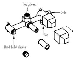
Une fois le mur fini, retirez les éléments de protection du corps de robinet comme indiqué sur le schéma. Faites glisser la plaque décorative sur les boutons jusqu'à ce qu'elle soit en contact avec le mur.
