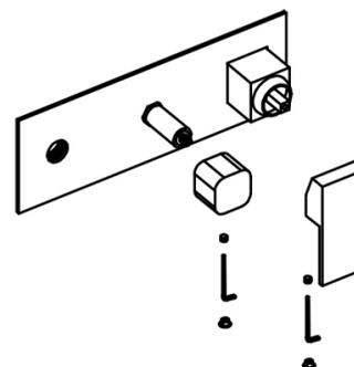
Installez la poignée et le bouton inverseur puis utilisez la clé Allen pour serrer les vis de fixation.
