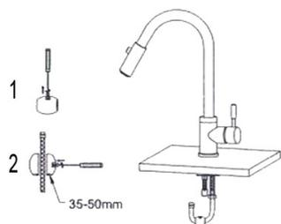
Ouvrez le contrepoids à l'aide d'un tournevis et placez le sur le flexible du bec en le faisant glisser doucement vers le bas.
