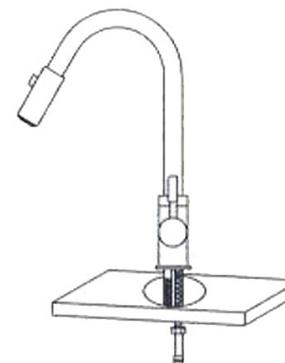
Insérez les flexibles et le tuyau fileté dans le trou de l'évier ou du plan de travail.
