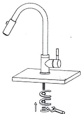
Placez le joint en caoutchouc, suivi de la rondelle métallique et de l'écrou de montage.
