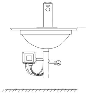
Fixez la plaque au mur à l'aide des vis fournies. Puis, placez le boîtier sur le mur en le faisant coulisser sur la plaque. Connectez enfin le flexible du robinet au boîtier puis le flexible d'alimentation en eau au boîtier.
