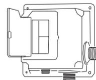
Ouvrez le couvercle du boîtier puis retirez la batterie. Placer les piles 1,5 V (non fournies) puis remettez la batterie dans le boîtier et fermez le couvercle.
