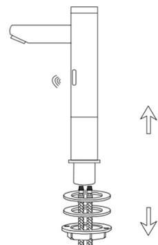
Placez la rondelle en caoutchouc puis la rondelle métallique sur la tige filetée, en les faisant glisser jusqu'à ce qu'ils soient en contact avec le dessous du support du robinet. Serrez à la main l'écrou.
