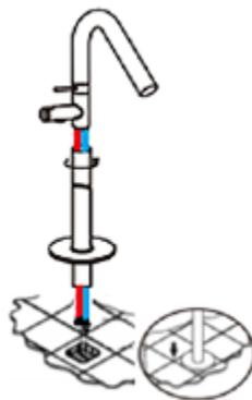
Assemblez le tube droit et le corps du robinet puis placez délicatement la plaque décorative et le support à boulons. Connectez les flexibles au corps d'encastrement et fixez les écrous du support avec les 4 vis. Abaissez délicatement la plaque décorative sur le sol.
