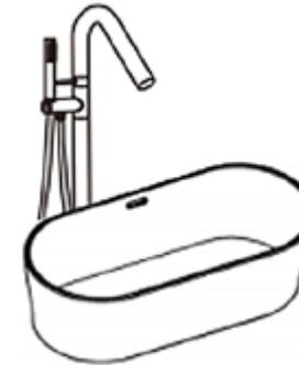
Connectez le flexible de douche au corps principal et à la douchette à main. Veillez à insérer les joints d'étanchéité dans chaque extrémité du flexible de douche. Vissez la tablette sur le bras du robinet et serrez les vis à l'aide de la clé Allen.
