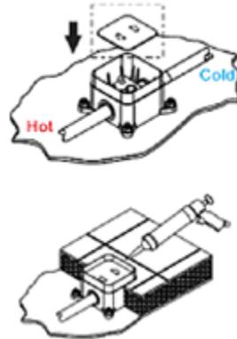
Remplacez le couvercle sur le corps d'encastrement pour réaliser la pose de votre revêtement de sol. Appliquez du silicone pour combler l'écart entre le boîtier et le revêtement de sol.
