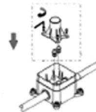
Installez le manchon noir en plastique sur le boîtier d'encastrement. Ouvrez l'alimentation en eau pendant quelques minutes afin de vérifier qu'il n'y a pas de fuites.
