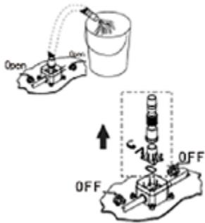
Positionnez la sortie du tuyau dans un seau puis ouvrez la vanne pour procéder à la purge du système. Une fois les impuretés évacuées, fermez la vanne et retirez le tuyau et le manchon du boîtier d'encastrement.
