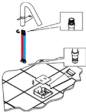
Lorsque le silicone est sec, retirez le couvercle et coupez la partie supérieure du boîtier à l'aide d'un cutter. Ensuite, vissez les flexibles dans le corps principal du robinet.
