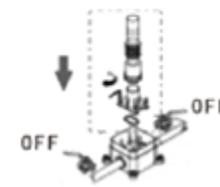
Coupez l'alimentation en eau, puis retirez le manchon du corps d'encastrement. Fixez le tuyau de vidange sur le manchon, puis remplacez-le soigneusement dans le boîtier.
