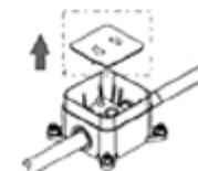
Fixez à l'aide des vis le boîtier d'encastrement. Connectez les tuyaux d'eau chaude et froide au corps encastré. Serrez à la clé à molette les contre-écrou sans trop forcer. Retirez ensuite le couvercle du boîtier d'encastrement mais gardez-le à portée de main.
