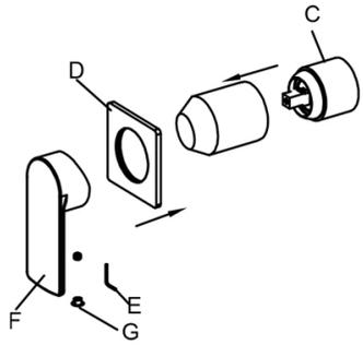
Retirez le couvercle de protection du corps d'encastrement. Positionnez la plaque décorative (D) sur la cartouche (C) et installez la poignée (F) puis serrez à l'aide de la clé Allen.
