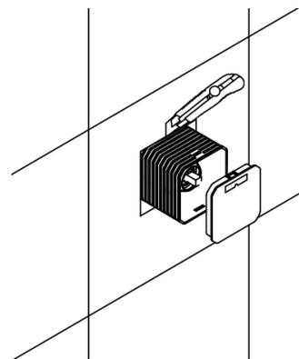
Une fois le revêtement mural posé, retirez le couvercle de protection. Si besoin, découpez au cutter l'excédent du boîtier de façon à ce qu'il affleure la surface du mur.
