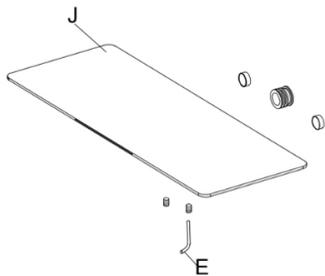
Vissez le bec sur la tige filetée, puis utilisez la clé Allen pour serrer les vis de fixation.
