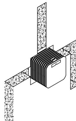
Découpez dans le mur l'emplacement du corps d'encastrement, selon ses dimensions, et des tuyaux d'eau, type PER, cuivre... (non fournis). Placez le corps d'encastrement dans le mur puis fixez-le à l'aide du tournevis après avoir vérifié son horizontalité. Enroulez le filetage des tuyaux d'alimentation en eau de ruban téflon. Connectez les tuyaux d'arrivée d'eau chaude et froide au boîtier d'encastrement. Ouvrez l'alimentation pour vérifier qu'il n'y a pas de fuites puis fermez l'eau.
