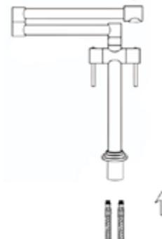
Vissez à la main les flexibles dans le corps du robinet. Attention, ne pas utiliser de clé pour serrer les flexibles car cela pourrait les endommager.
