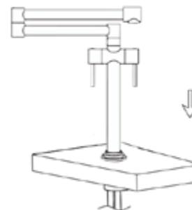
Insérez les flexibles et le tuyau fileté dans le trou de l'évier ou du plan de travail.
