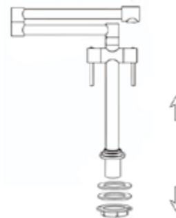
Retirez l'écrou de montage, la rondelle métallique et le joint en caoutchouc du tuyau fileté.
