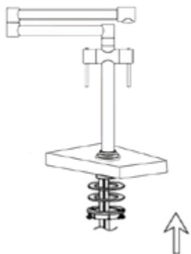
Placez le joint en caoutchouc, suivi de la rondelle métallique et de l'écrou. Serrez à la main puis à l'aide d'un tournevis, serrez les vis du contre écrou jusqu'à ce que le robinet soit bien fixé.
