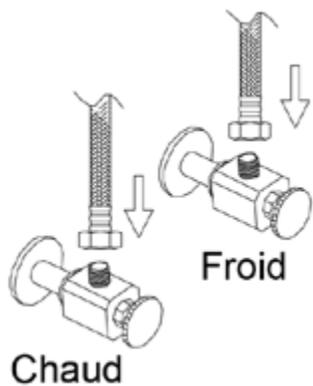
Vissez à la main les extrémités des flexibles sur l'alimentation en eau. Utilisez ensuite la clé pour serrer les écrous de fixation, sans trop forcer.
