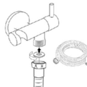
Vissez le flexible sur le support mural après avoir placé un joint d'étanchéité.
