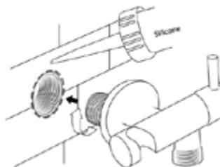
Appliquez un joint silicone autour de l'arrivée d'eau. Vissez dans le sens des aiguilles d'une montre, la tige filetée du support douchette sur la sortie d'eau murale à travers la platine.
