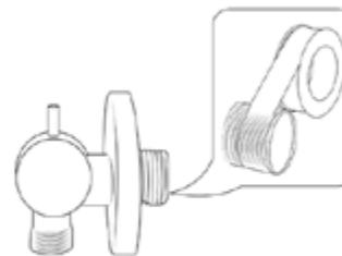
Avant d'installer le support douchette, il est recommandé de fixer une platine au mur. Cela renforcera le mur et lui permettra de supporter la charge du support et de la douchette. Elle doit être choisie en fonction des matériaux utilisés et des équipements installés. Pour commencer, enroulez le filetage du support mural de ruban téflon.
