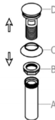
Démontez la bonde pour séparer les différents éléments qui la composent, à savoir, la partie supérieure (D), la bague de serrage (B), le joint en caoutchouc (C) et la partie inférieure (A).
