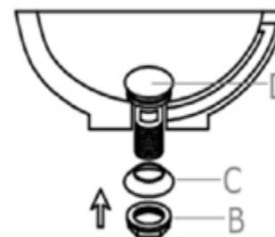
Sous le lavabo, insérez le joint en caoutchouc et vissez l'écrou de serrage à la clé à molette sans trop forcer pour ne pas endommager la bonde.
