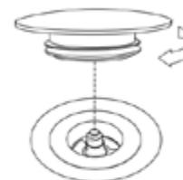
Vissez le clapet sur la bonde dans le sens des aiguilles d'une montre.
