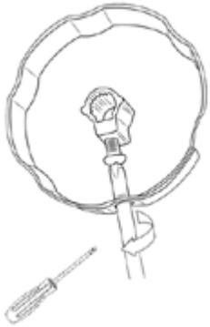
Utilisez un tournevis pour desserrer la vis du volant du trop-plein (sans la retirer) afin de désassembler les composants du trop-plein.
