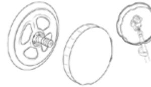
Positionnez le volant sur le clapet anti-retour, puis utilisez le tournevis pour serrer la vis en place.
