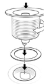
Prenez le joint et positionnez-le sur le trou du vidage interne du fond de la baignoire. Une fois le joint en place, insérez la bonde dans le trou de vidage de la baignoire.
