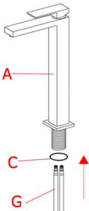
Insérez le joint torique (C) dans la rainure inférieure du corps du robinet (A).
