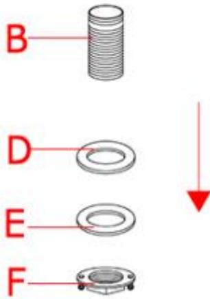
Retirez l'écrou de montage (F), la rondelle en poly (E) et la rondelle en caoutchouc (D) du tuyau fileté (B).
