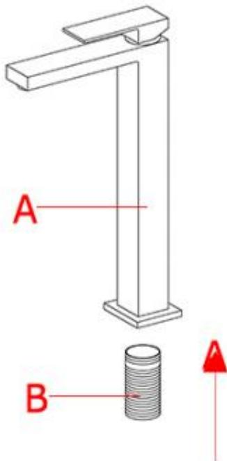
Vissez le tuyau fileté (B) dans le corps du robinet (A).
