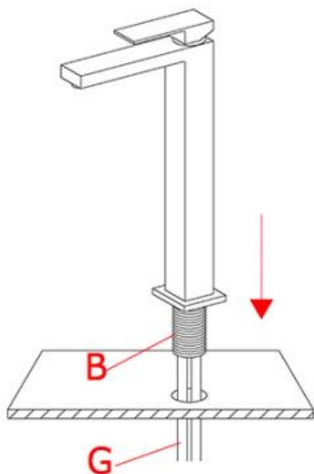
Insérez les flexibles (G) et le tuyau fileté (B) dans le trou de l'évier.
