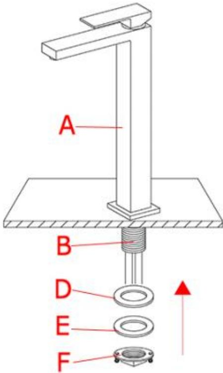
Remettez la rondelle en caoutchouc (D), la rondelle en poly (E) et l'écrou de montage (F) sur le tuyau fileté (B).
