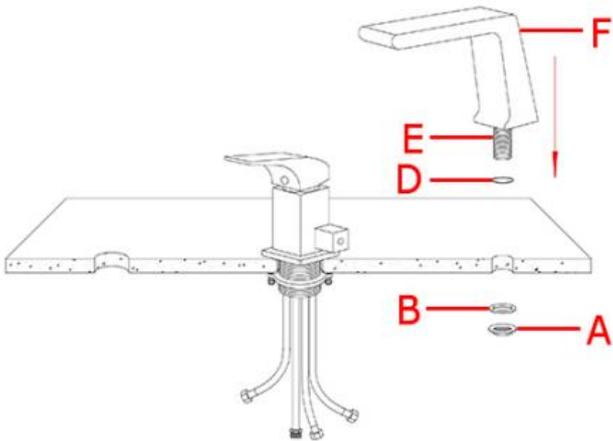
Montez le joint torique (D) et insérez le corps du bec (F) dans le trou de forage spécifié sur le comptoir.
