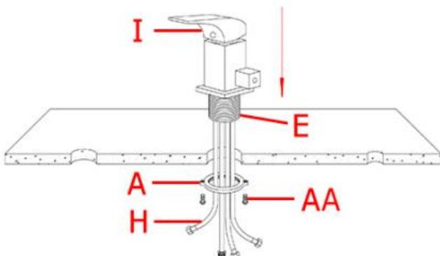
Insérez les conduites d'eau (H) et le tuyau fileté (E) dans le trou de forage spécifié sur le comptoir. Vissez l'écrou de montage (A) sous le comptoir. Placer correctement la poignée (I) et serrer l'écrou de montage (A) avec les vis (AA).
