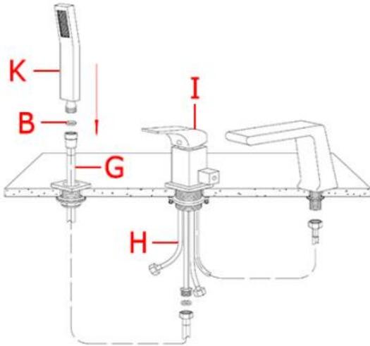
Ajoutez des rondelles en caoutchouc (B) aux deux extrémités et connectez le tuyau de douche (G) à la douchette (K) et à la conduite d'eau correspondante (H) au bas de la poignée (I).
