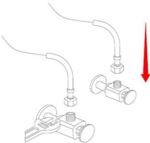
Connectez les conduites d'eau chaude et froide à la conduite principale d'alimentation en eau.
