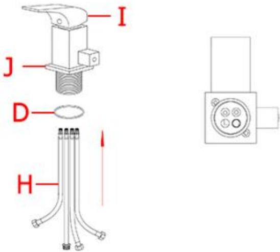
Insérer le joint torique (D) dans la rainure inférieure de la plaque de base (J). Visser les conduites d'eau (H) dans le trou de vis correspondant de la poignée (I)
