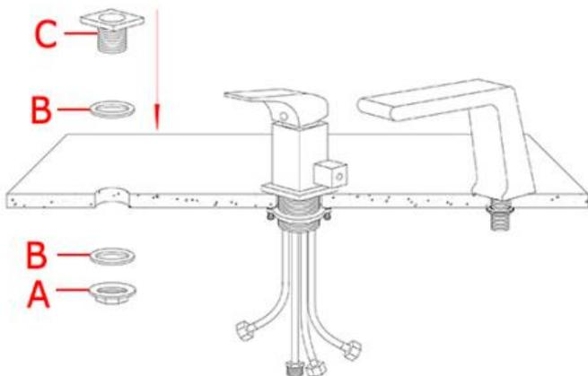
Installez la rondelle en caoutchouc (B) et insérez le support de douchette (C) dans le trou de forage spécifié. Mettez la rondelle en caoutchouc (B) et vissez fermement l'écrou de montage (A) sous le comptoir.
