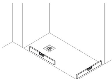
Placez le receveur de douche en alignant le trou de vidange. Assurez-vous qu'il est de niveau et terminez l'installation de la bonde. Testez l'installation pour vérifier que l'eau s'évacue correctement.
