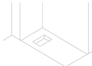
Appliquez du mortier sur la surface où le receveur de douche sera positionné pour créer une base parfaitement plane et nivelée. Laissez sécher avant de procéder à l'installation.
