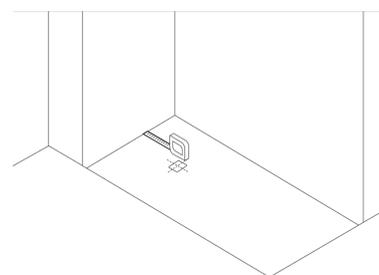
Mesurez et tracez au crayon l'espace nécessaire de la bonde et des raccords en plomberie.
