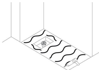
Appliquez du mastic polyuréthane sur la surface au sol, sur la partie inférieure du receveur de douche et sur tout le pourtour du receveur, côté mur.
